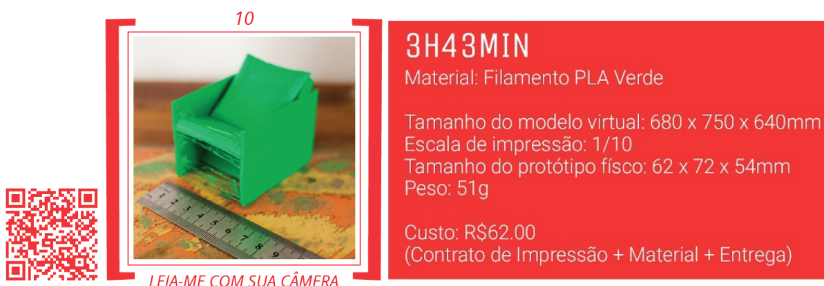
Figura 10: Objeto modelado em dispositivo de Realidade Virtual e fabricado em prototipagem rápida com impressora FDM. Conteúdo interativo ser acessado também pelo portal: < www.camilaghendov.wixsite.com/conteudosinterativos >.
